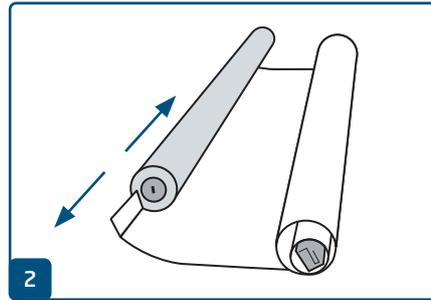
2 Rimuovere il riavvolgitore automatico ed estrarre da quest'ultimo l'estremità inferiore del banner. Rimuovere l'asticella dalla parte inferiore del banner. Aprire l'asticella per rimuovere l'estremità superiore del banner.
