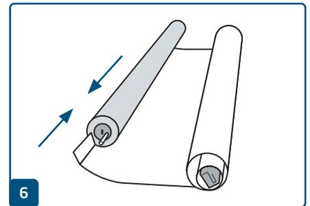
6 Inserisci lateralmente l'estremità inferiore del banner con l'asticella nel riavvolgitore automatico.
