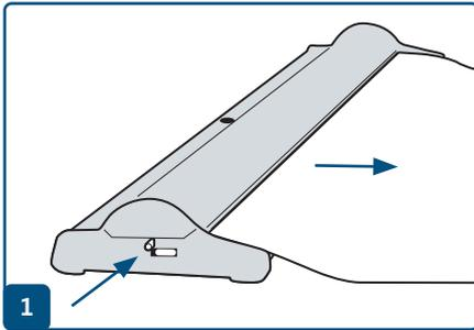
1 Sostituzione del banner: Estrarre completamente la stampa. Inserire il perno di bloccaggio. Aprire la cassetta cliccando i tasti laterali.
