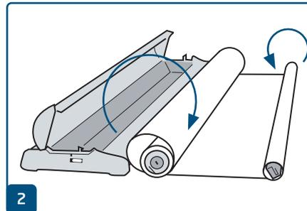
Das Banner mit Federkern entnehmen und komplett auf die obere Klemmschiene aufwickeln.
