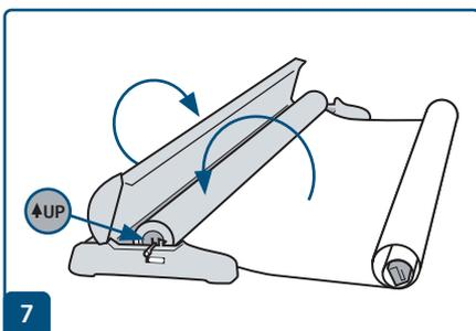
**7** Den Kern mit Banner in das Gehäuse setzen, den Rest des Banners außen liegen lassen. Dann den Deckel schließen.
