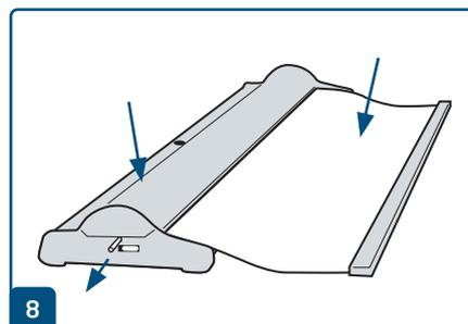
Den Deckel schließen, das Banner festhalten und den Sicherungsstift entfernen. Dann den Druck langsam einziehen lassen.
