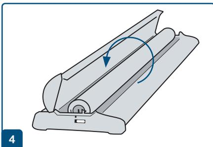
Den leeren Federkern in die Kassette einlegen und 35 mal drehen.
