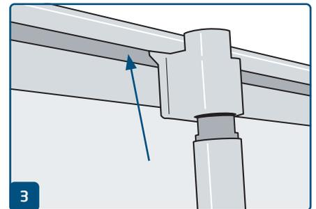
Lassen Sie die Plastikhalterung an der Oberseite der Stange in die Klemmleiste einrasten.
