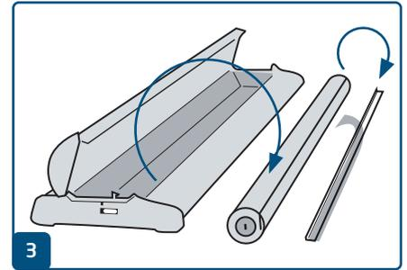
**3** Konfektionierung: Gehäuse mittels Tasten öffnen und den Federkern entnehmen. Den Keder aus dem Federkern ziehen und den roten Klebeschutz abziehen.
