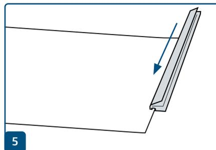
**5** Klemmleiste öffnen und das obere Ende des neuen Bannerdrucks einsetzen. Die Leiste wieder schließen.
