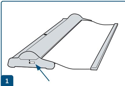
Die Deckklappe mittels Betätigen der kleinen Tasten (an beiden Seiten) öffnen.
