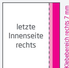
Der **Klebebereich** mit dem Umschlag ist 7 mm breit und befindet sich auf der ersten Innenteilseite am linken Seitenrand und auf der letzten Innenteilseite am rechten Seitenrand. Dieser Bereich entspricht der Klebefläche und ist später nicht mehr sichtbar. Trotzdem sollten angrenzende Druckelemente 2 - 3 mm in den Verbundbereich hineinragen, um Blitzer zu vermeiden.
