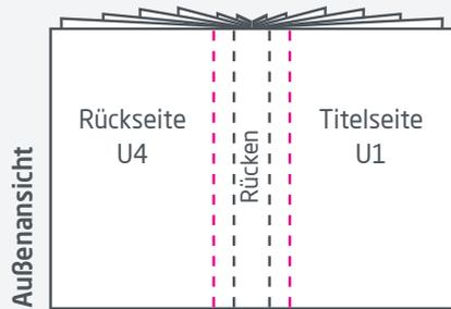
Die **Rillung** erfolgt beiderseits des Rückens sowie im Abstand von 7 mm zum Rücken (am Ende der Klebefläche).
