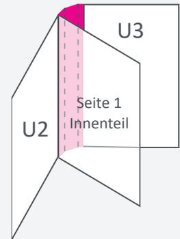
Im **druckfreien Bereich** (Rückenbereich) dürfen keine Elemente platziert werden, da diese Klebefläche für eine optimale Leimhaftung unbedruckt bleiben muss. Um den bestmöglichen Verbund zwischen Innenteil und Umschlag zu gewährleisten, sollte die Klebefläche rechts und links vom Rücken (Seitenleimung) zusätzlich um jeweils 4 mm erweitert werden.
